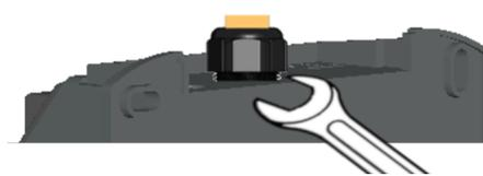
Abb. 6-15: Kabelverschraubung von der Rückseite festziehen
